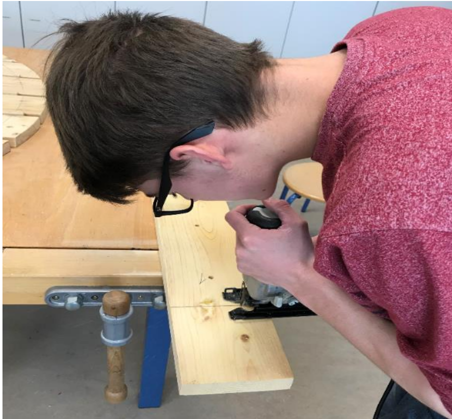
Abbildung 30: Genaues Ablängen mit richtiger Handhaltung war erforderlich
