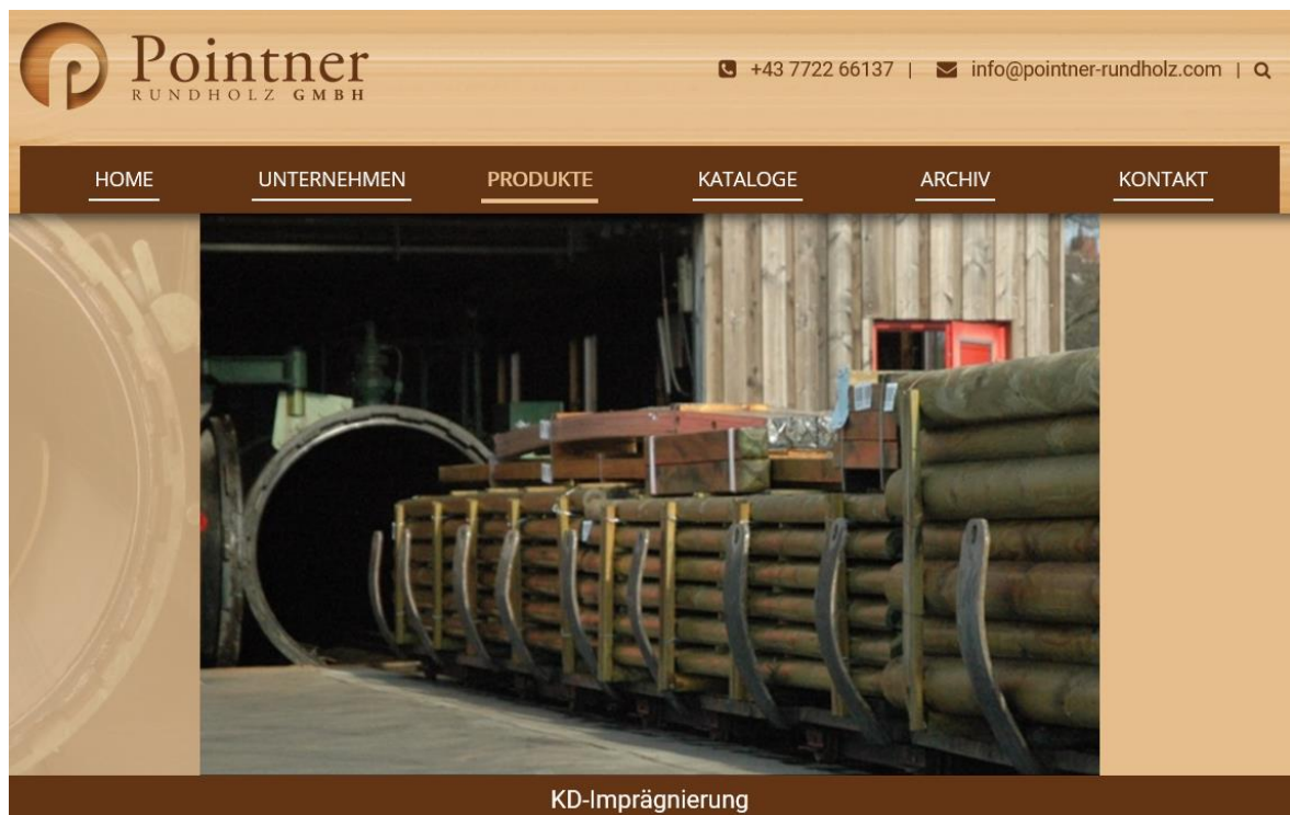
Abbildung 34: Imprägnierte Rundhölzer vor dem Imprägnierungskessel der Fa. Pointner
