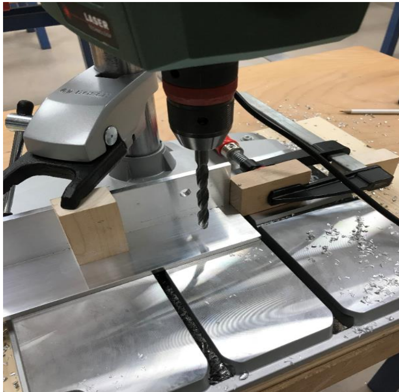
Abbildung 12: Vorrichtungen mit Anschlägen erleichterten das Bohren
