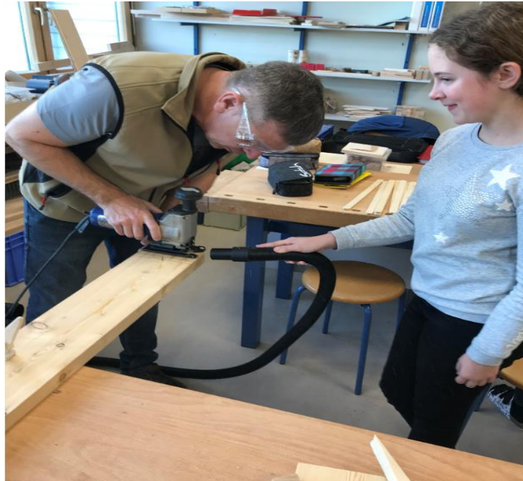
Abbildung 20: Handhabung der elektrischen Stichsäge mit Absaugung
