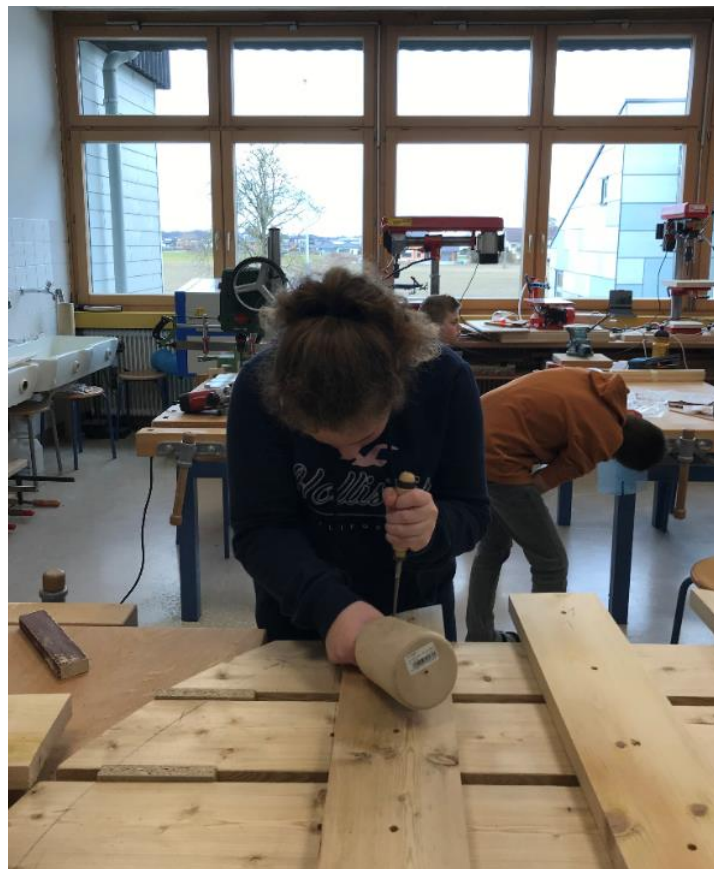
Abbildung 32: Die Bretter wurden mit dem Stemmeisen nummeriert
