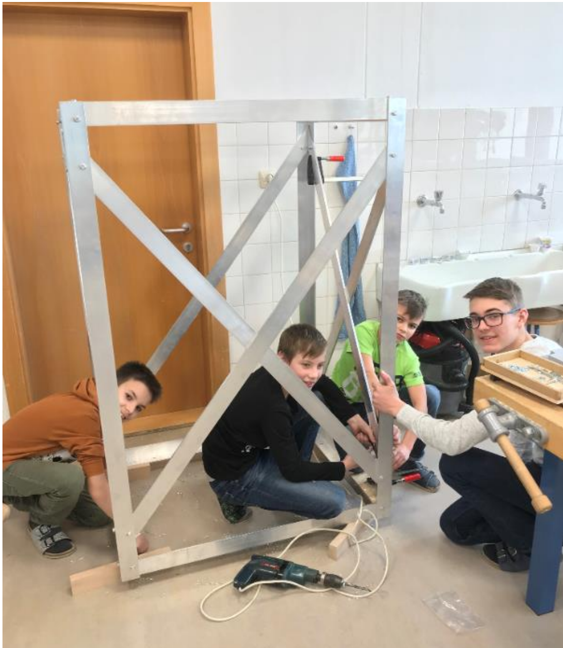
Abbildung 16: Die Diagonalstreben verleihen dem ALU-Gestell noch mehr Stabilität
