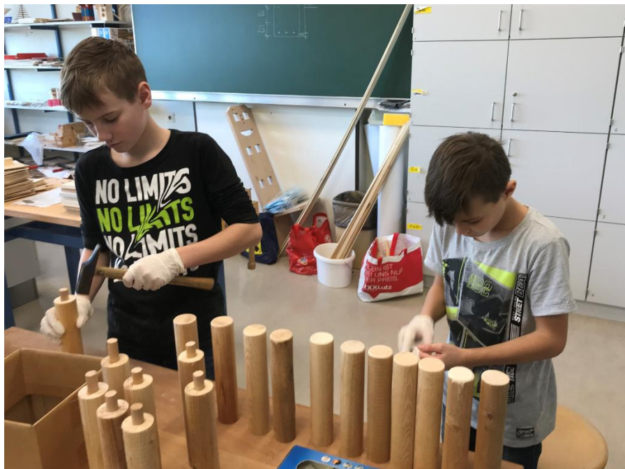
Abbildung 28: Die Dübel wurden mit einem PU-Kleber eingeklebt
