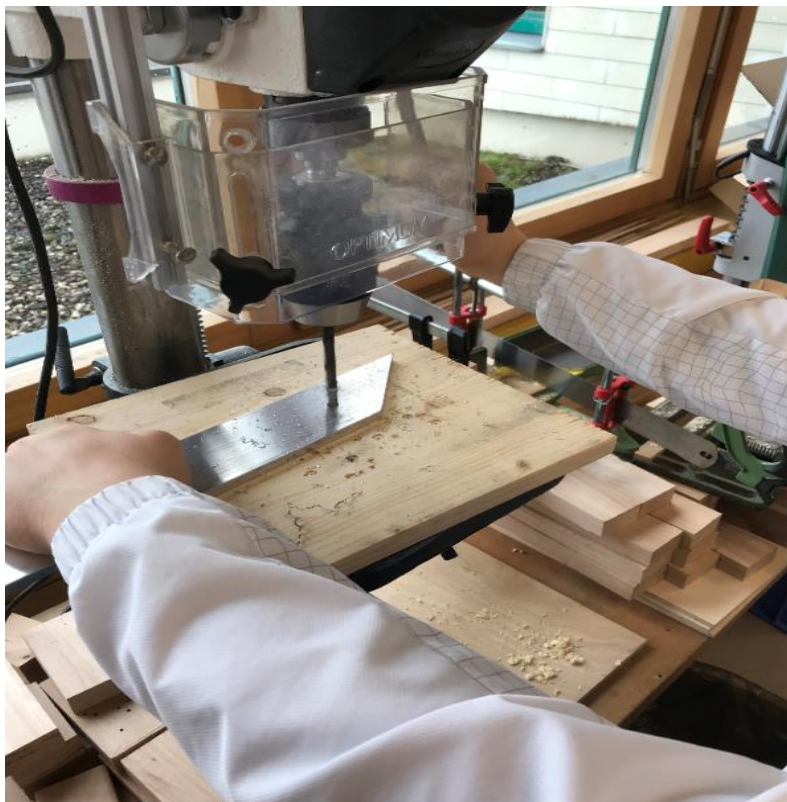
Abbildung 12: Vorrichtungen mit Anschlägen erleichterten das Bohren
