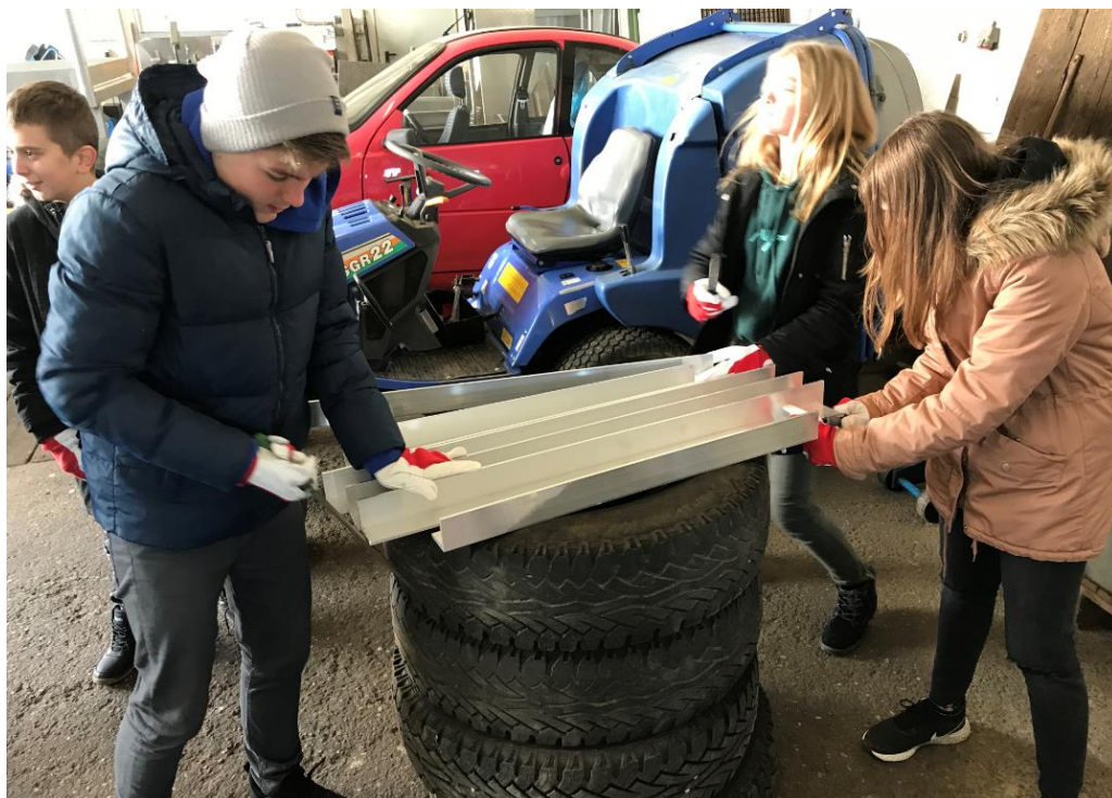
Abbildung 9: Die Kanten der abgesägten Profile wurden mit der Schlichtfeile entgratet
