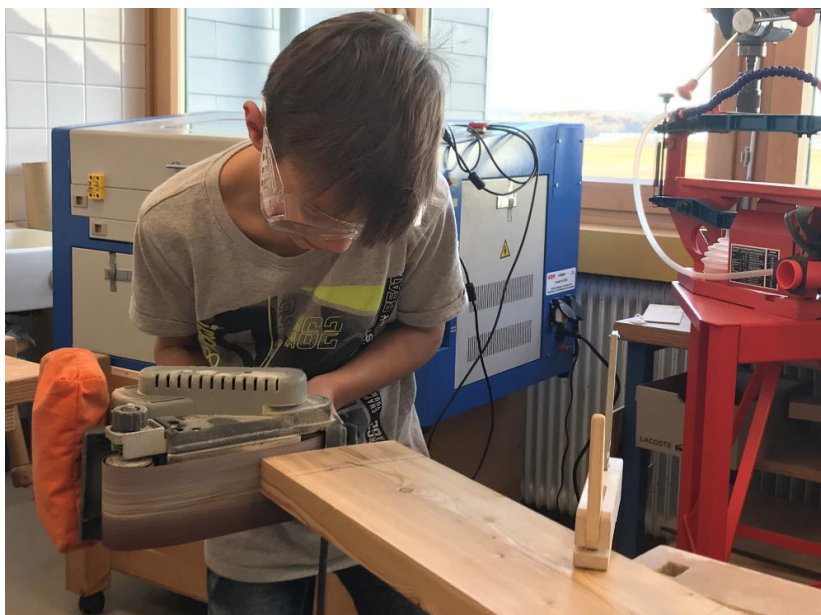
Abbildung 23: Kante wurde mit der Handbandschleifmaschine geschliffen
