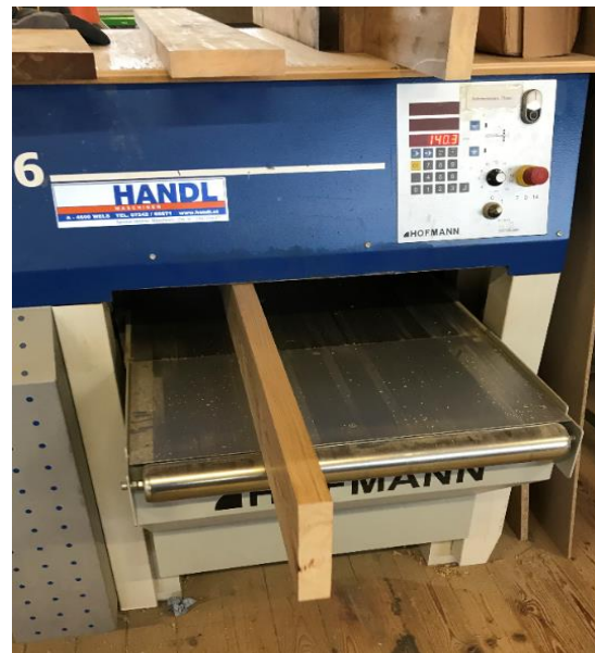
Abbildung 17: Die Bretter wurden mit den großen Hobelmaschinen gehobelt
